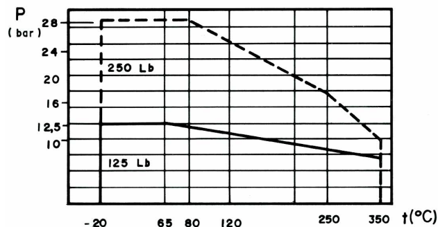
Fig. 3 - Bridas ANSI B 16.1. Presión admisible en función de la temperatura.
