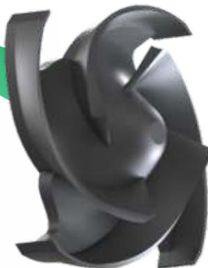
O **rotor** é aberto, radial de fluxo único, possuem palhetas traseiras que compensam o empuxo axial e impedem o depósito de sólidos na parte traseira.
