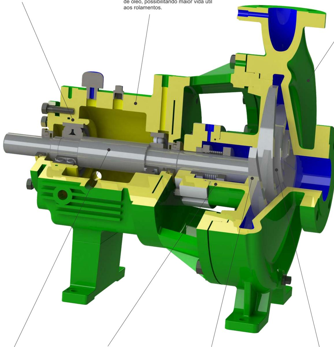
Eixo rígido, desenvolvido para uma deflexão mínima, menor que 0,05mm, visando melhor condição de selagem, conforme requisito normativo.
