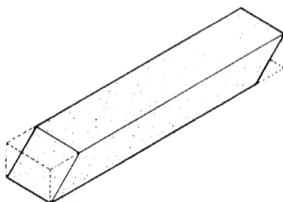
Para o corte dos anéis da gaxeta, aconselhamos utilizar um dispositivo simples conforme mostra a figura abaixo:
