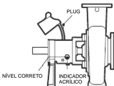
A primeira troca de óleo do mancal deve ser feita após as 200 primeiras horas de operação do equipamento, após a primeira troca realizar as trocas de óleo lubrificante a cada 2000 horas de operação ou a cada 3 meses. (utilizar o prazo que vencer primeiro).
