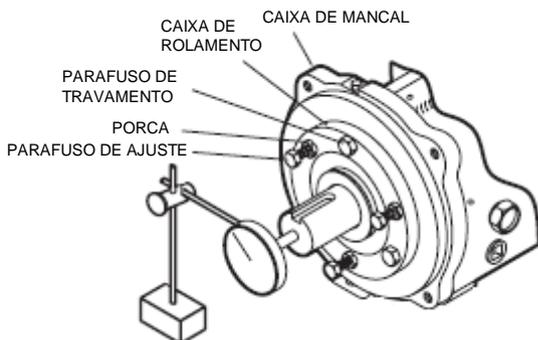
Zere o relógio comparador e solte os parafusos de travamento aproximadamente uma volta.
