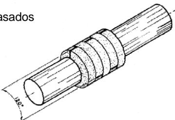
Verifique se o eixo pode ser girado após a montagem de cada anel, coloque o aperta-gaxeta prensando o último anel, aperte as porcas com as mãos e gire o eixo para certificar-se de que ele não encosta no aperta-gaxeta.
